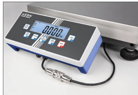
**2** Eichstecker, ermöglicht bei geeichten Waagen das Trennen von Auswertegerät und Plattform ohne die Eichung zu zerstören, z. B. für einen nachträglichen Einbau der Waage in einen Pack- und Versandtisch, Grubenrahmen etc. Bitte beim Kauf der Waage mitbestellen
