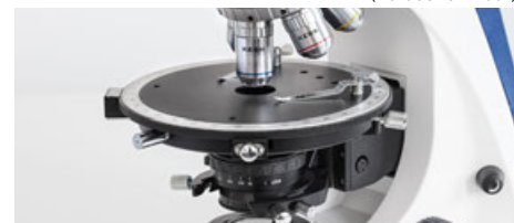
Zentrier- und drehbarer Polarisations-Objekttisch
