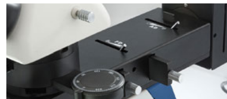
Bertrand-Linse, \lambda Slip, 360° rotierbarer Analysator (herausnehmbar)
