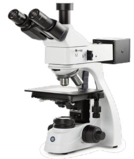
**bScope Fluoreszenz-Mikroskope, mit 100 W Hg-Lichtquelle****BS.3153-
