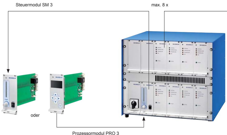
Kernstück der Generatoren sind einheitliche Leistungsmodule bis 1500 W mit Regelung aller Arbeitsparameter durch einen Mikroprozessor on board.
