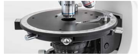
Zentrier- und drehbarer Polarisations-Objektstisch
